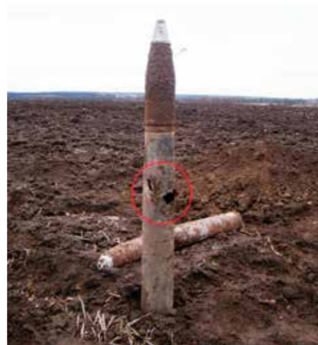
Előtalált magyar 1929/33 M repezgránáttöltény (elől), 1929/32 M légvédelmirepezgránát-töltény (hátul). A repezgránát hüvelyén jól láthatóak a repezstálalat nyomai
