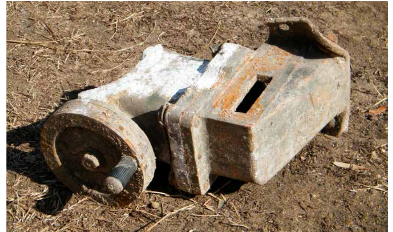
A feltételezhetően találat érte magyar 1929/38 M 8 cm-es löveg irányzóberendezésének maradványa, az oldal előretartás kézi kerekével
