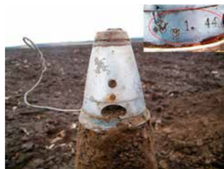
A repezgránát 1933 M gyújtója. A gyújtó oldalán látható jelzések a gyártás helyét (Magyar Királyi Állami Vas-, Acél- és Gépgyár, Diósgyőr IMÁVAGI, Vadásztöltény-, Gyutacs- és Fémárugyár Rt., magyar-róvári gyára), a szériaszámot (1) és a gyártási évet (1944) adják meg
