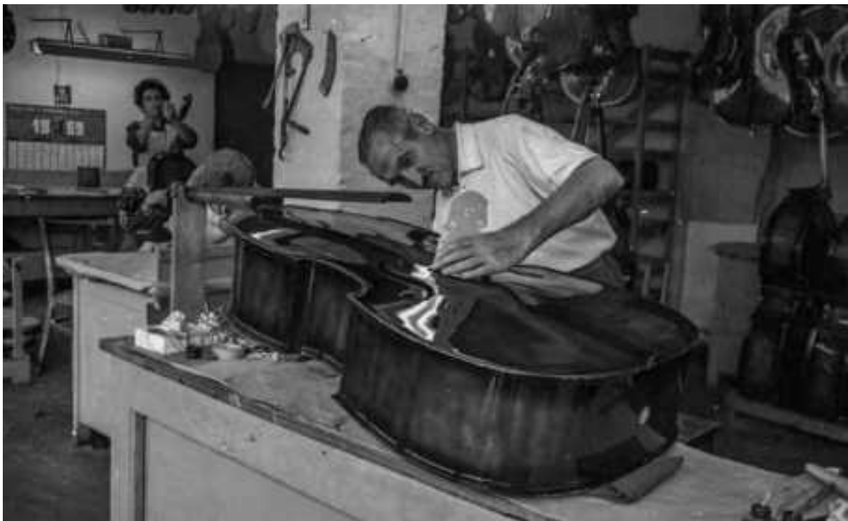
8. kép: Bőgő a munkapadon. Fogas Géza szemléli a nagybőgő húrlábának illeszkedését a hangszertest hasára a Szegedi Hangszergyárban. 1969. augusztus. Móra Ferenc Múzeum, Történeti negatívok, 28981. Készítő: Liebmann Béla.
